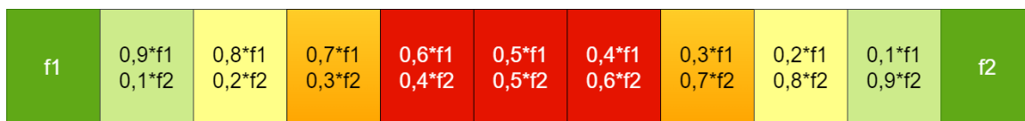
Figuur 30 Principeschets overgang tussen kalibratievlak met waarde f1 (links) en een kalibratievlak met waarde f2 (rechts) in calibration_section_polygons
