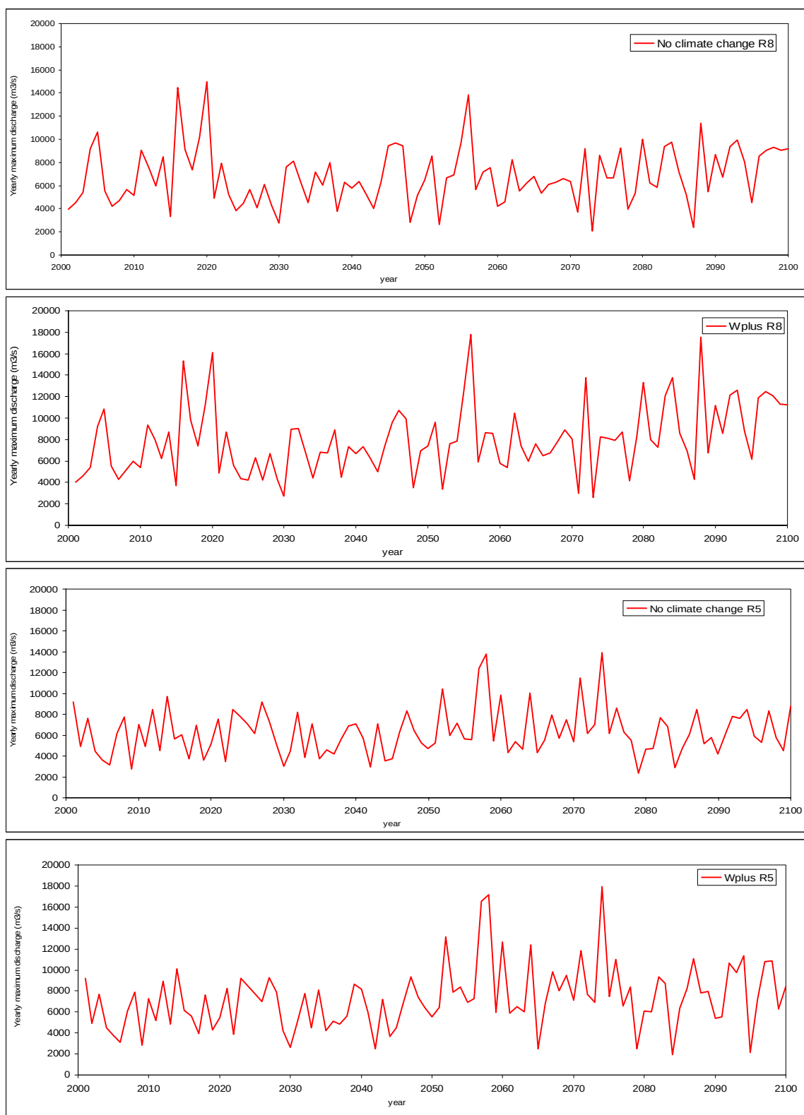
Figuur G.2 Transient scenario's voor 2 verschillende klimaatrealisaties (aangegeven met realisatie 5 en 8) voor een situatie zonder klimaatverandering en klimaatverandering volgens het Wplus scenario. In '95 zijn mensen in de Betuwe geëvacueerd toen rijnaafvoer rond de 12000 m³/s was.
