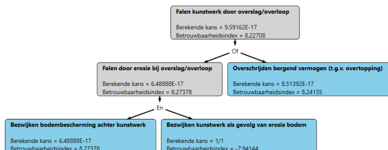
Figuur 21.12: Foutenboom met de berekende kansen voor de geselecteerde windrichting
