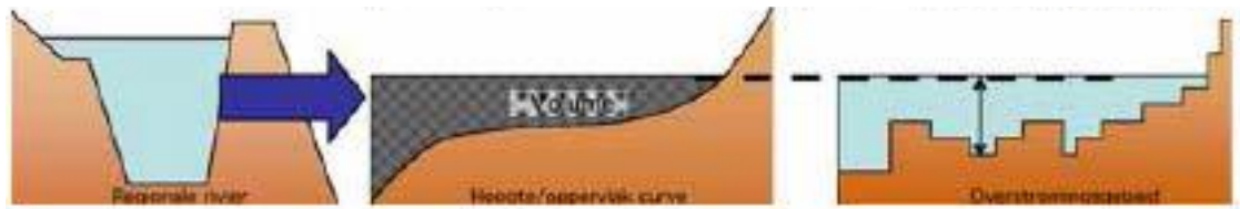
Figuur 2.2 Vertaling van debiet door een bres naar waterstand in een bedreigd gebied en van waterstand naar waterdiepte (uit Slager & Van der Doef, 2014).
