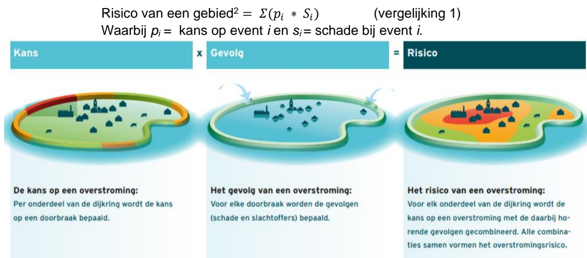
Figuur 4.1 Schematische weergave van de berekening van het overstromingsrisico van een dijktraject op basis van de analyse van dijktrajectdelen. Bron: VNK2 atlas (Vergouwe, 2015).
