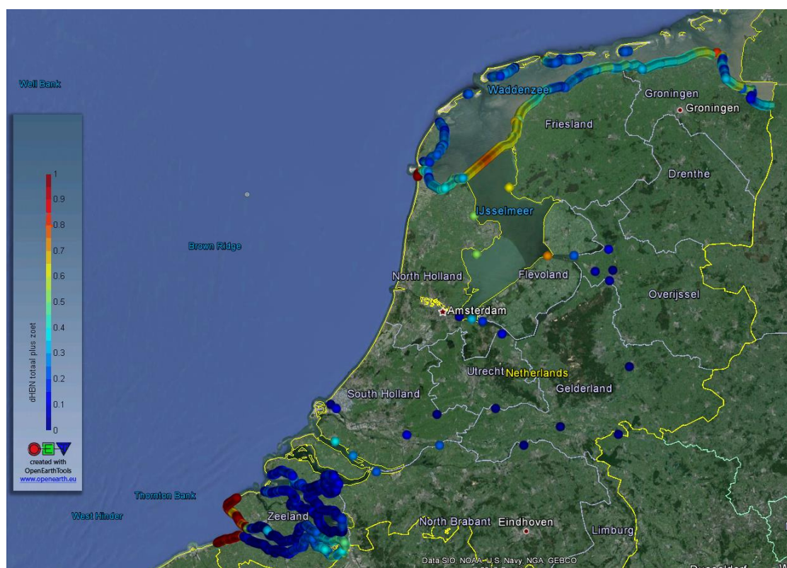
Figuur A.1 Effect robuustheidstoetslag op benodigde kruinhoogte (in meters) voor het faalmechanisme golfoverslag.
