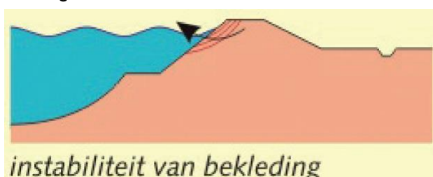
Figuur 5.1 Schematische weergave instabiliteit van bekleding, uit Ministerie van Verkeer en Waterstaat (2007)
