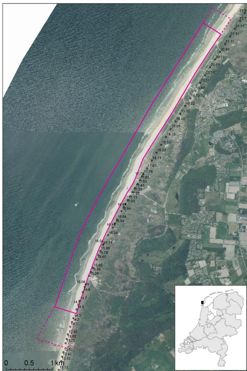
Figuur 4-1 Luchtfoto van de suppletie locatie uit 2023. De roze polygoon toont de raai begrenzing van het suppletievak inclusief uitloopraai (stippellijnen).
