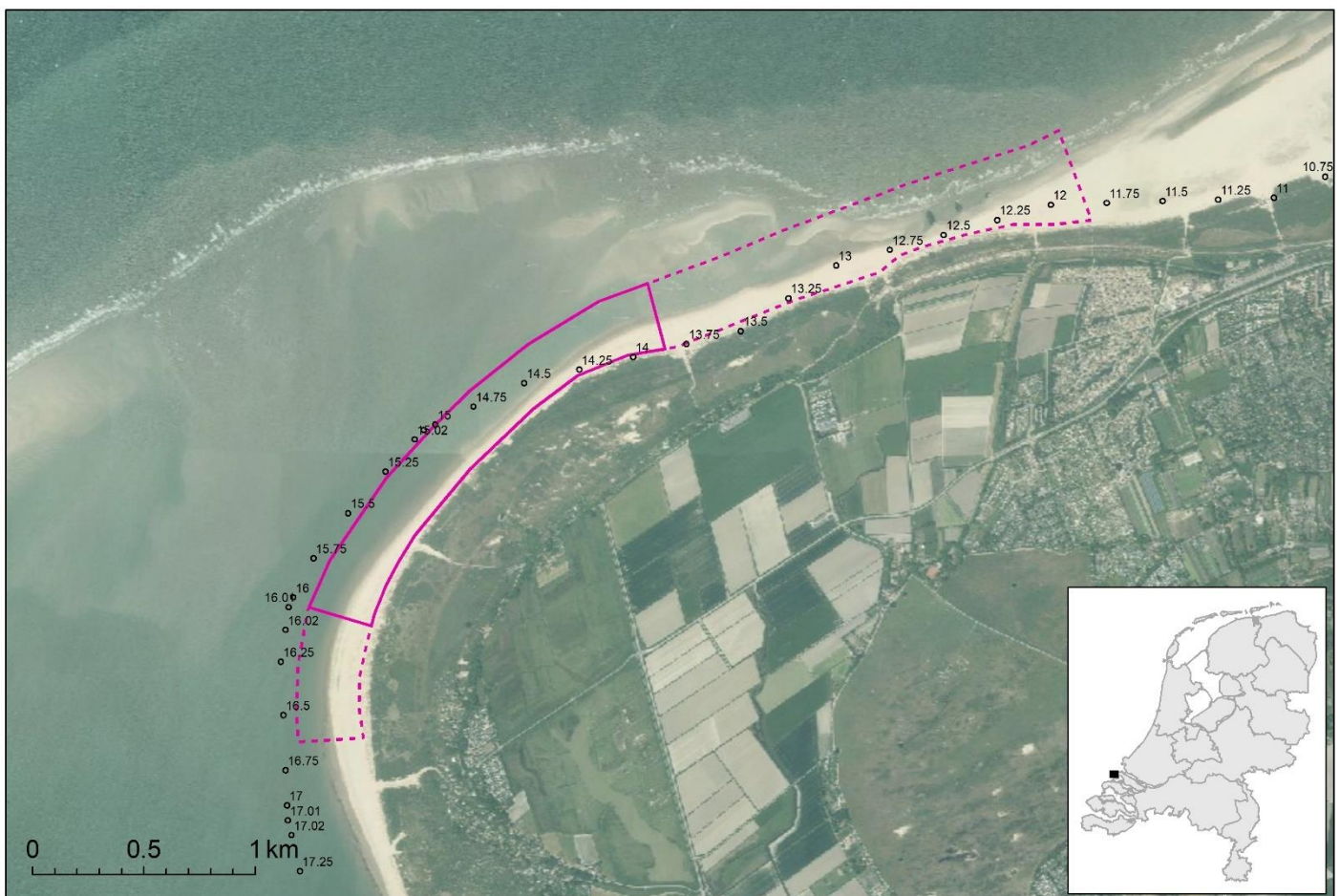
Figuur 4-1 Luchtfoto van de suppletielocatie uit 2023. De roze polygoon toont de raai begrenzing van het suppletievak inclusief uitloopraaien (stippellijn).
