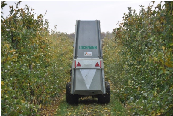
Figuur 1 Lochmann NL dwarsstroomspuit met Air Closing System, uitvoering NL 300.
