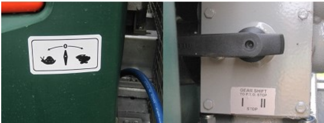
Figuur 6 Stand van de overbrengingsverhouding van de aftakas op de ventilator op de Lochmann NL dwarsstroomspuit met ACS (links: indicatie op de spuittank en rechts: stand van de tandwielkast met behulp van een handgreep (hendel)).
