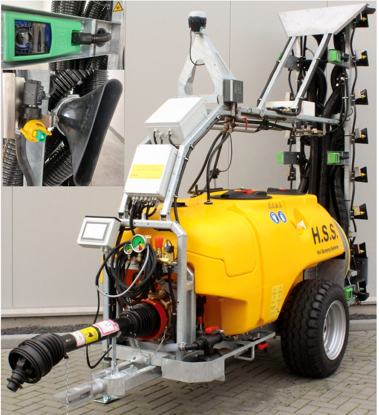
Afbeelding 1. H.S.S. CF dwarsstroombomgaardspuit met I.S.A. met linksboven detectiesensor en daaronder spuitdophouder met PWM-module.
