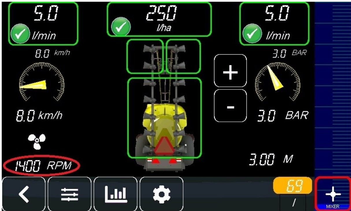
Afbeelding 5. Monitoring van het maximale ventilatortoerental (zie rode cirkel links) van 1400 rpm door het bedieningspaneel.
