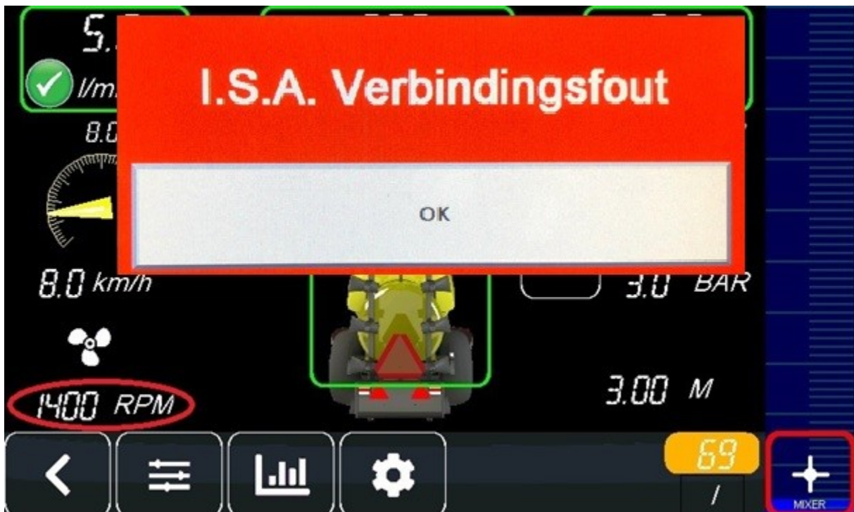
Afbeelding 4. H.S.S. Controlbox met foutmelding functioneren I.S.A.
