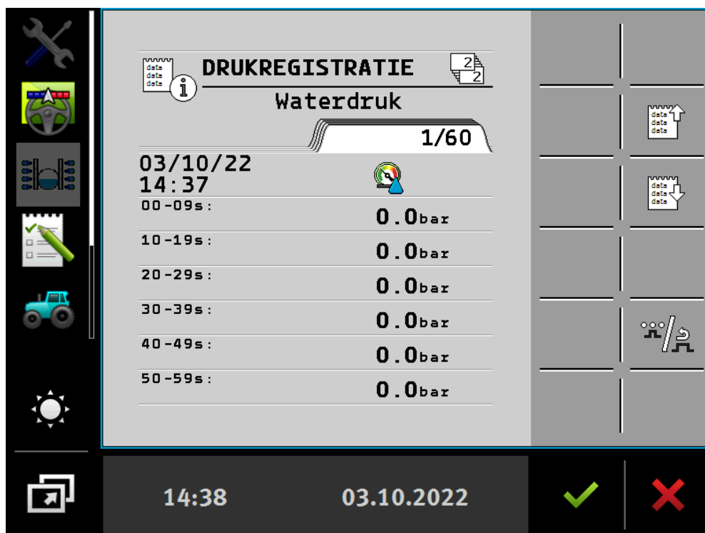
Figuur 4 Drukregistratievoorziening waarmee spuitdruk (staat als waterdruk op scherm) is af te lezen per interval van 10 seconden. Gedurende maximaal 1 uur worden spuitdrukwaarden opgeslagen in het systeem.
