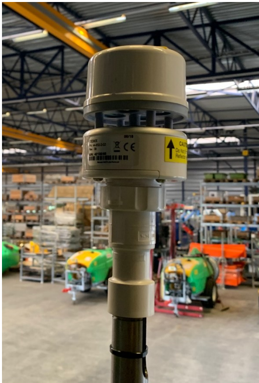
Figuur 3 Afbeelding weerstation/windsensor op de dwarsstroomsput
