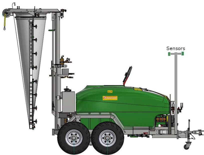
Figuur 7 Positionering van de 2 LiDAR-sensoren
