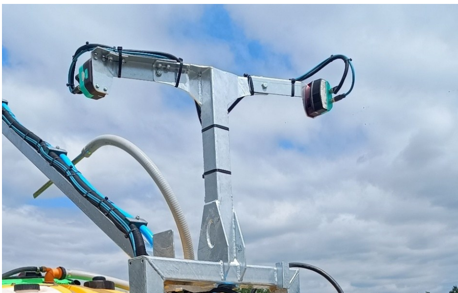
Figuur 8 LiDAR-sensor met kijkhoek aan elke zijde op de dwarsstroomspuit
