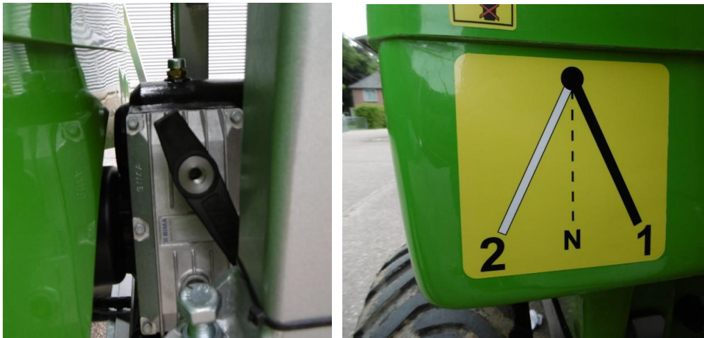
Figuur 3 De versnellingsbak van beide ventilatoren wordt door middel van een hendel in de juiste luchtinstelling gezet: Stand 1 voor lage luchtinstelling Stand 2 voor hoge luchtinstelling Stand N voor Neutraal = uitgeschakeld
