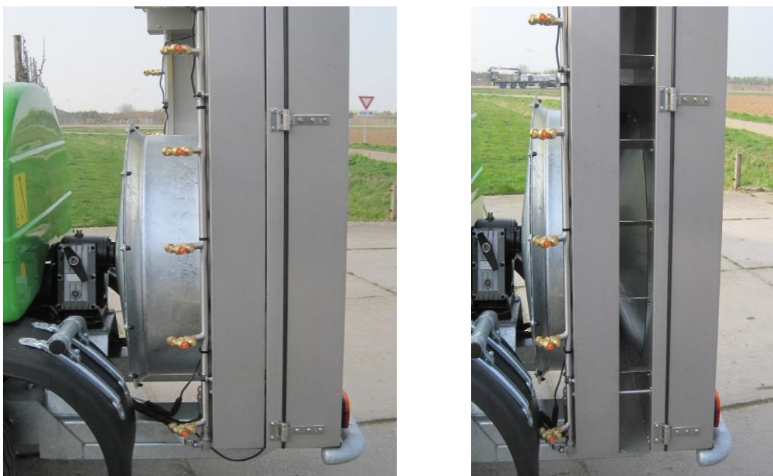
Figuur 2 De luchtklep (DRS-klep) van de dwarsstroomspuit Streamline. De grootte van de luchtuitstroomopening kan links en rechts onafhankelijk worden ingesteld met de terminal in de cabine van de tractor. Op de linker foto is de luchtklep 0% geopend Op de rechter foto is de luchtklep 100% geopend
