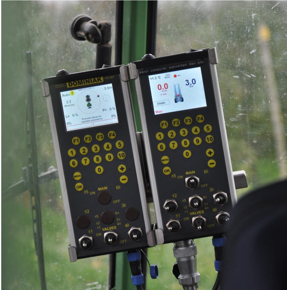
Figuur 5 In de cabine van de tractor zitten twee terminals: 1. De linker terminal regelt de instelling van de luchtkleppen 2. De rechter terminal regelt het spuiten (o.a. spuitdruk zichtbaar)
