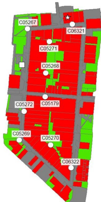
Figuur 4-2 Ligging peilbuizen (C-nummers) en rioelgemaal (wit vierkant). Van peilbuizen C5271 en C5272 zijn geen hoogfrequente metingen beschikbaar (Bron: Rutten, 2013).
