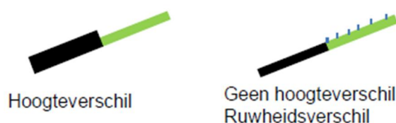
Figuur 2-8: Categorisering naar hoogteverschil en ruwheidsverschil volgens [DLT-ovgA 2013]
