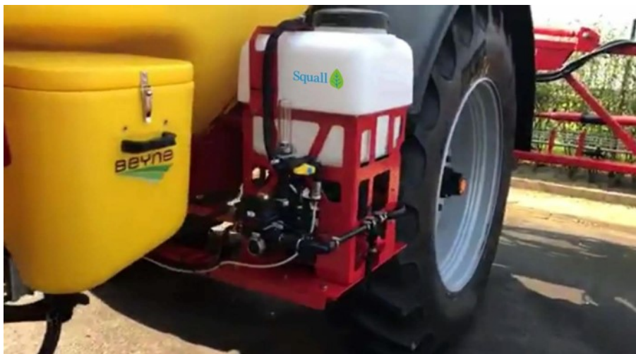
Figuur 2: Een voorbeeld van een opgebouwd injectiesysteem op een veldspuit waarmee Squall vanuit een tank kan worden geïnjecteerd. In de tractor kunnen de gelogde gegevens op een eenvoudig scherm worden ingesteld en uitgelezen (zie figuur 3).
