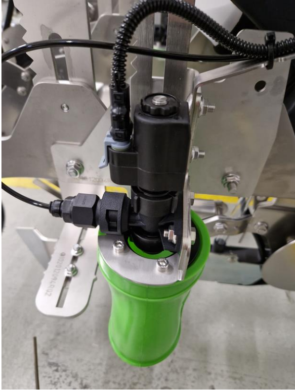
Foto: Montage van pulserende spuitdop met flexibele windscherm/afscherming op de FarmDroid spotsprayer
