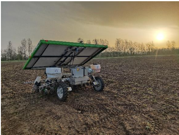
Foto: FarmDroid FD20 in het veld met open zonnepaneel (niet in de operationele modus)
