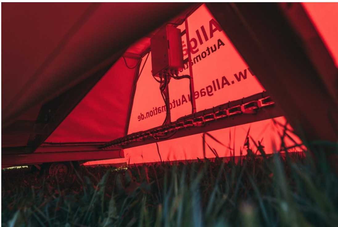
Figuur 5 Binnenkant van een module met spuitleiding en spuitdoppen.
