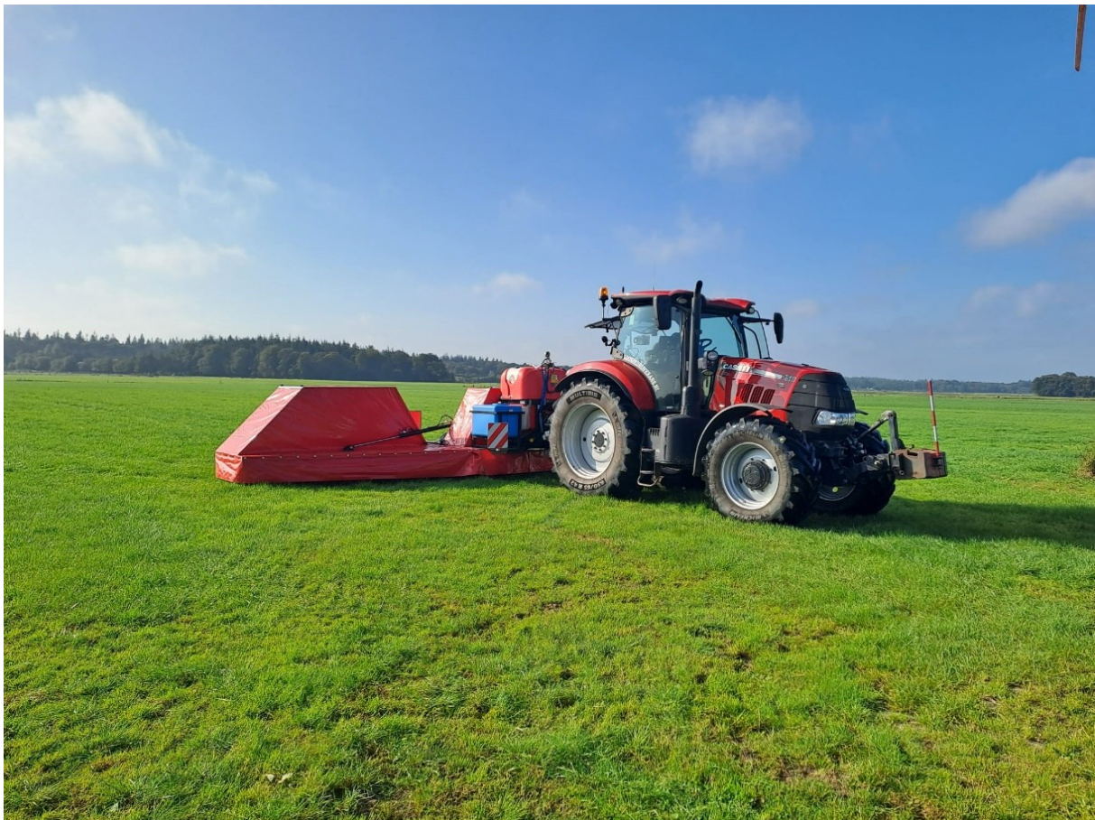
Figuur 4 Rondom de spotsprayer zijn flexibele kunststof zeilen gemonteerd, die de ruimte tussen het frame en de grond of het gewas zo veel mogelijk afsluiten.
