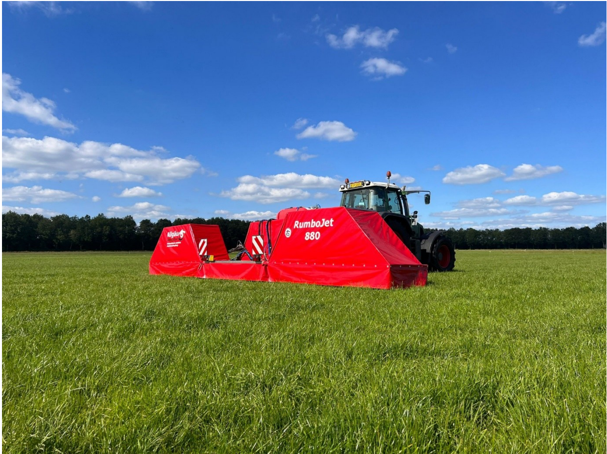
Figuur 1 De Allgäu Automation RumboJet 880 spotsprayer met volledig omsloten overkapping bestaande uit flexibele kunststof zeilen. De spuitdoppen van deze spotsprayer zijn gemonteerd onder de zeilen overkapping. Deze overkapping strekt zich uit over de drie modules van de spotsprayer en beschermt de camera's en spuitleidingen tegen omgevingsinvloeden, zoals wind en licht.
