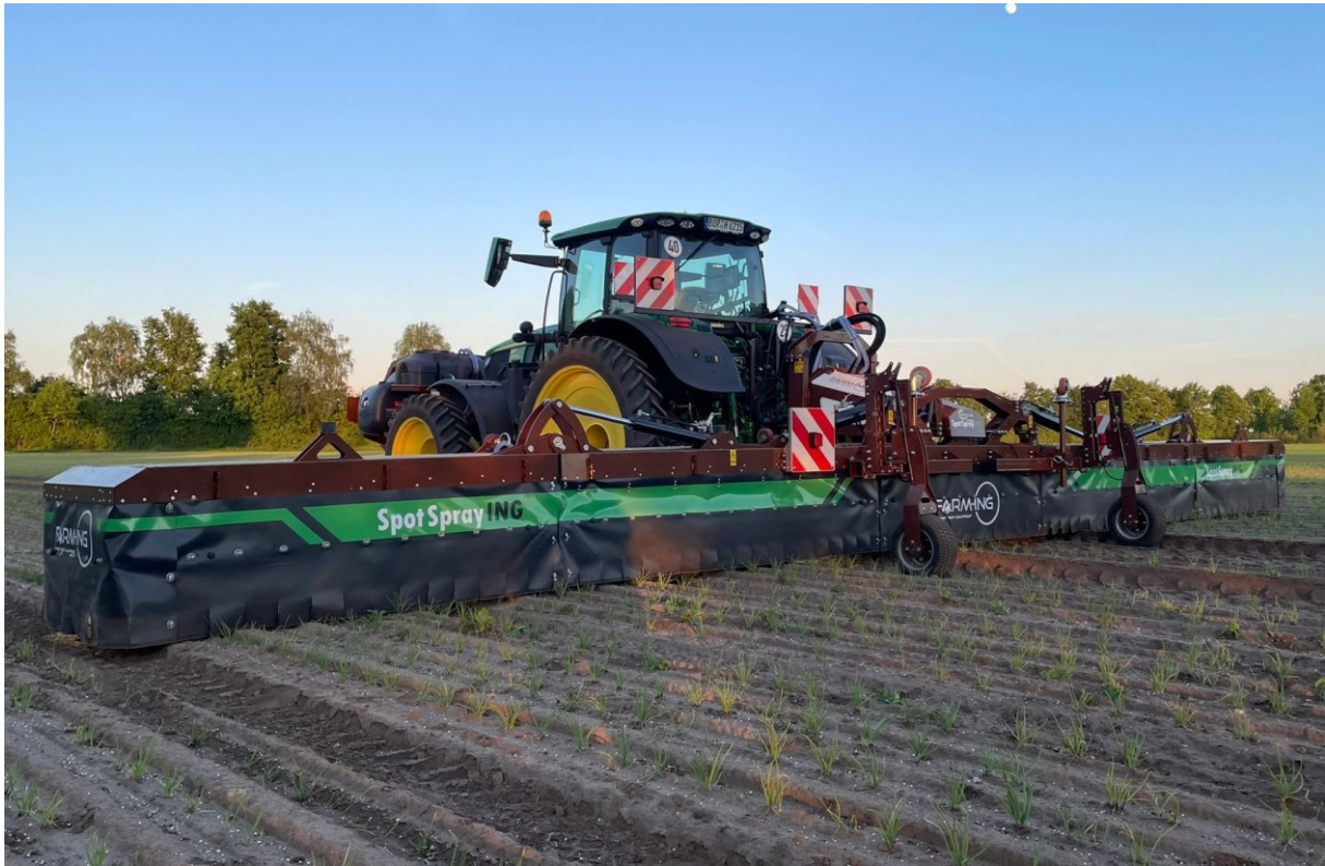
Figuur 1 Farm-ING SpotSprayING Precisie Spotsprayer (modelvariant 9.180: werkbreedte 9 meter en 180 spuitdoppen) met geheel omsloten overkapping.
