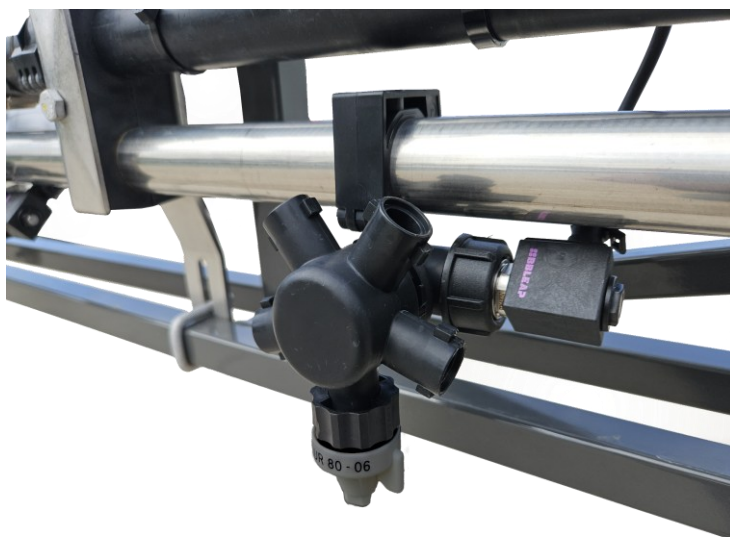
Foto 4: Detail van een spuitboom met opbouw van BBLeap PWM-klep en Wilger COMBO-JET UR 80-06 spuitdop.
