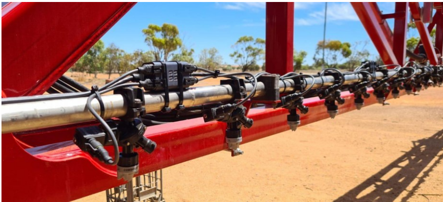
Foto 1: Smitboom met Leapbox opbouw. Te zien zijn de klepmodules, PWM-kleppen en Wilger spuitdoppen. Hier is het systeem achteraf opgebouwd op een bestaande veldspuit.
