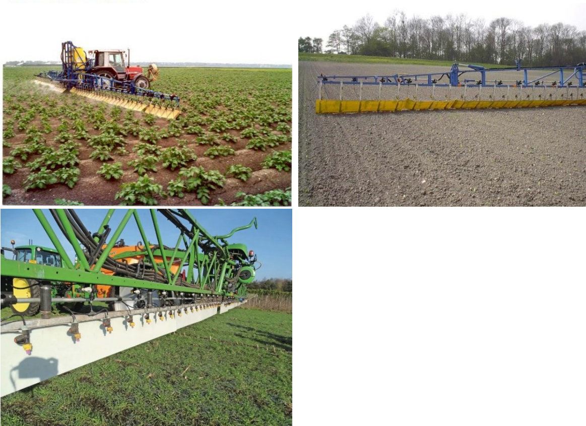
Figuur 2. Werkingsprincipe van het Släpduk spuitsysteem op kale grond en in een gewas (naar: Enfält et al., 2000)
