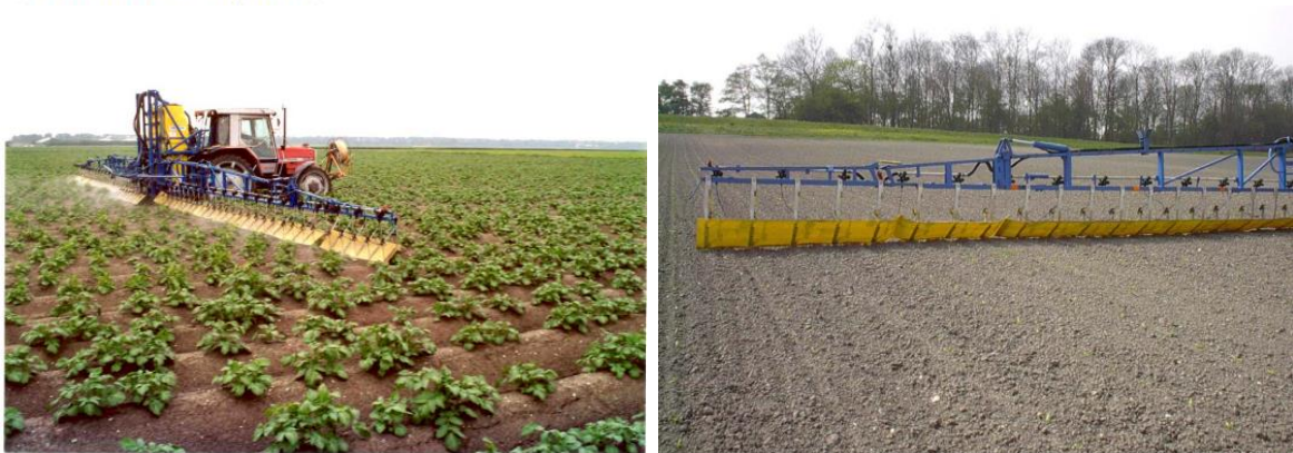
Figuur 3: Foto's veldspuit met Sleepdoekstelsysteem (bron: IMAG-WUR Nota P 2003-05, 'Gebruiksmogelijkheden van het Släpduk spuitsysteem in aardappelen, bieten en graan', januari 2003 (Van de Zande et al., (2003)).
