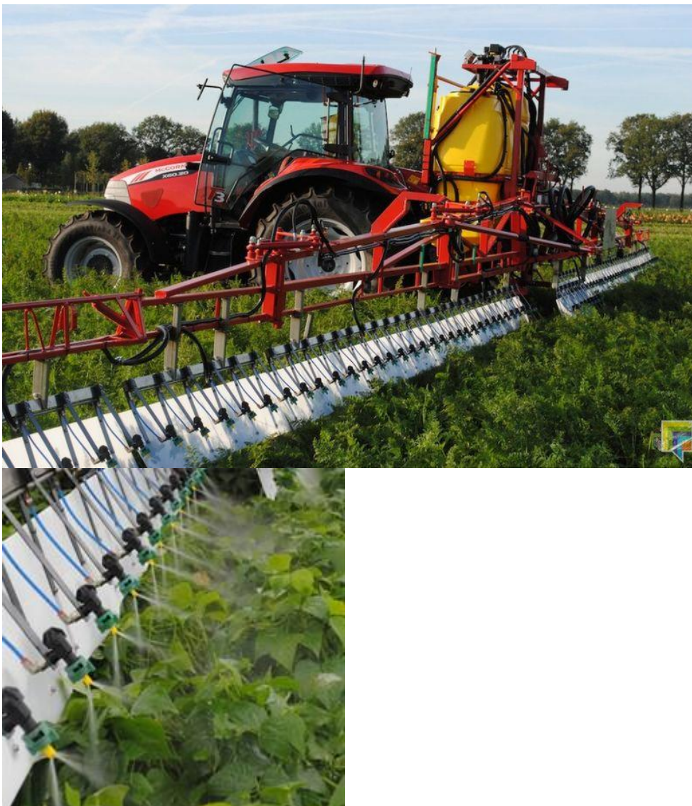
Figuur 4: Foto's van veldspuit met Wingsprayer type Single Wing-systeem in werking in een gewas
