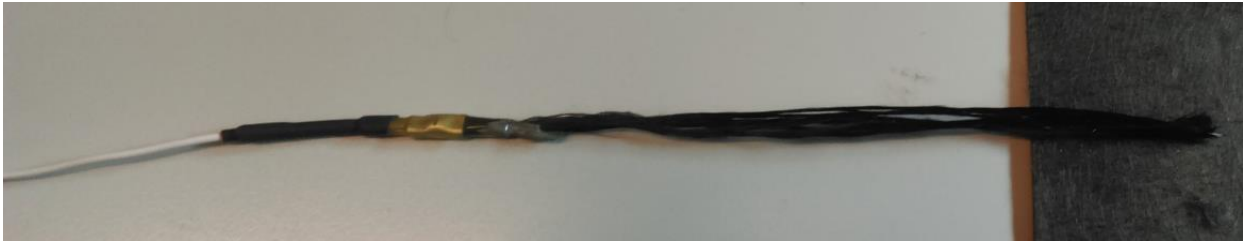
Figuur 3: ERT electrode ontwikkeld door de TU voor langdurige plaatsing in percolaat en in situ afvalcondities. De sensor bestaat uit koolstofvezel dat waterdicht gekoppeld is aan een koperdraad.
