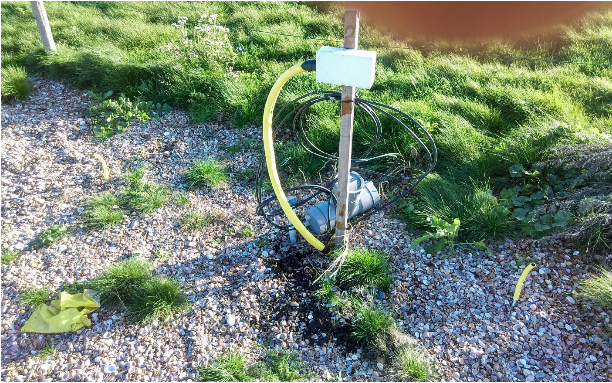
Figuur 14: Foto van een ERT connectiepunt op een van de proefvelden.
