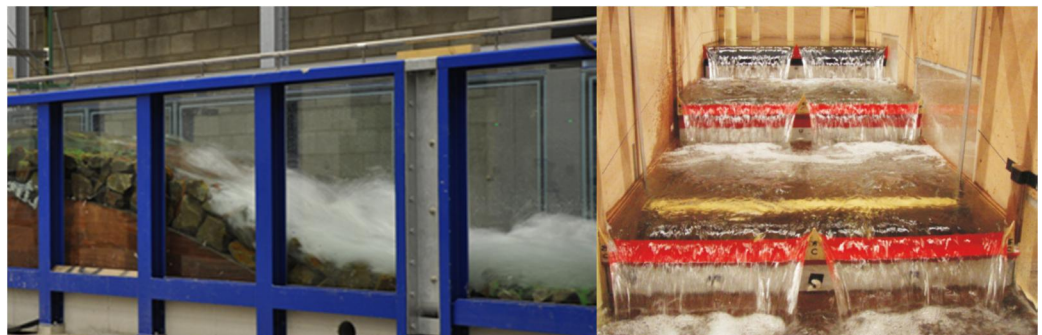
Figuur 49 2D Fysiek modelonderzoek bodembeschermingen (bron: Deltares)
