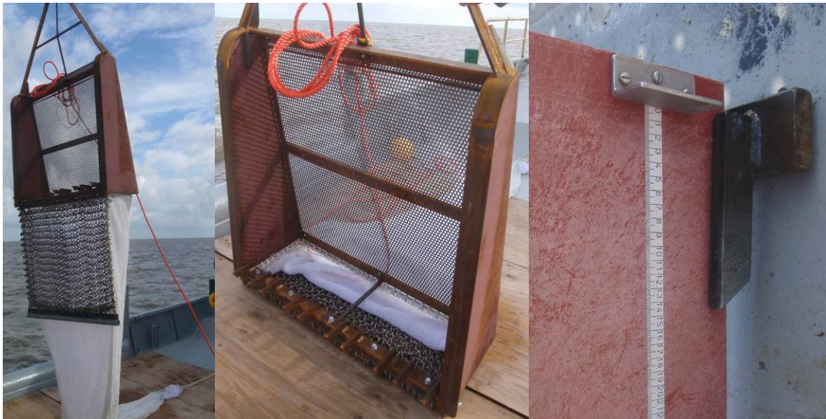
Figuur 2.3: De zandspieringkor hangend met de kettingmat achter de tanden (linker figuur), de kor staand op de tanden (middelste figuur) en één van de tanden met een totale lengte van 15 cm, waarvan 10 cm uitstekend om in de bodem door te dringen (rechterfiguur).
