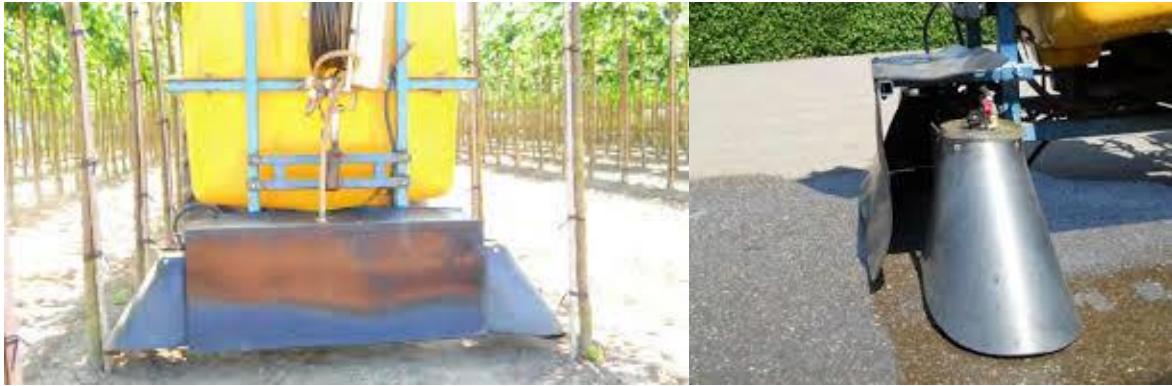
Figuur 1 Foto's van de kappenspuit met middenstuk en scharnierende stukken spuitboom met 5 spuitdoppen.
