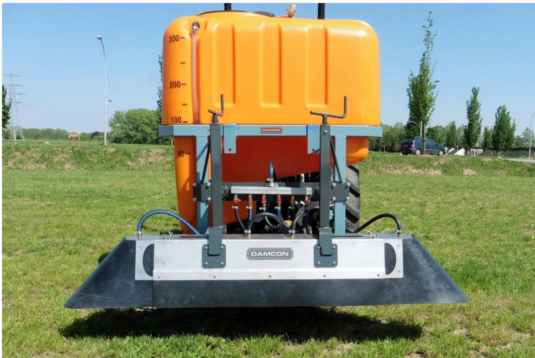
Figuur 2 Voorbeeld van onkruidspuit met vaste/niet-scharnierende uiteinden spuitboom, met kappen van flexibel materiaal dat om/langs de boom beweegt.
