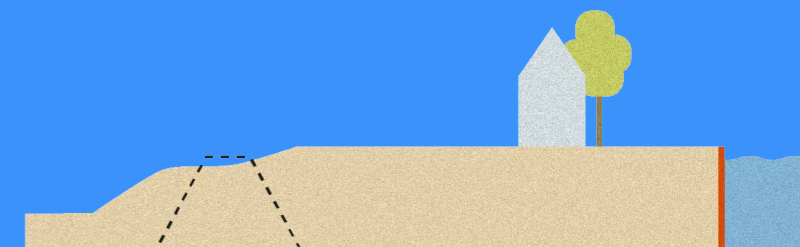
FIGUUR 29: Schematisatie Lopikerweteringkaade Zuid, waarin het leggerprofiel (gearceerd) niet meer voldoet aan de veiligheidseisen voor hoogte, maar de kans op een overstroming voldoende klein is vanwege het aanwezige voorland.
