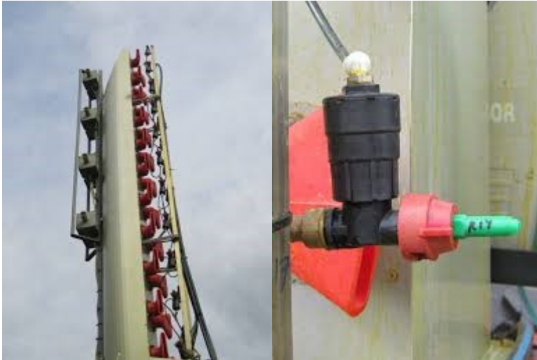
Figuur 3 : Mastspuit met 4 gasdetectiesensoren in de top (links) en een detailfoto van een spuitdop met individuele automatisch schakelende dopafsluiter (rechts).
