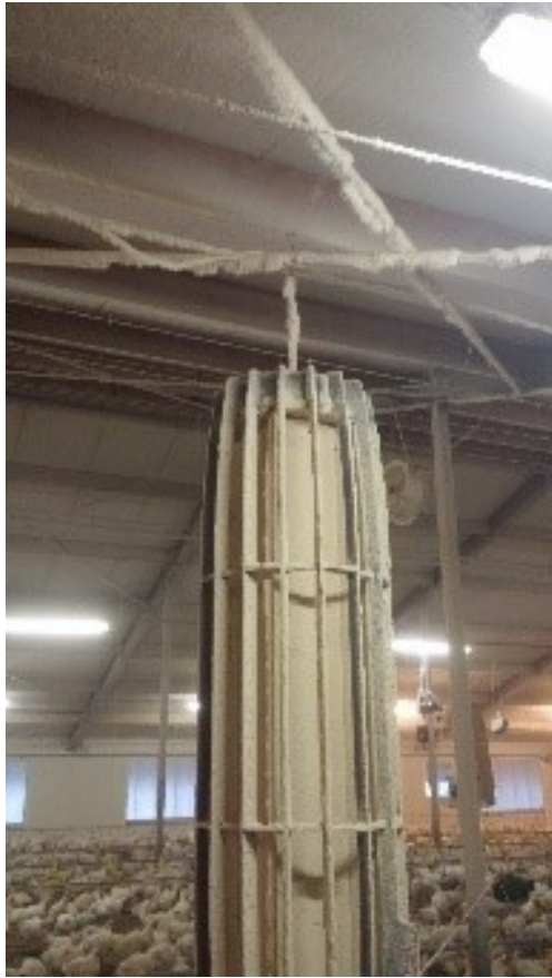
Figuur 1.4 Ionisatie-unit met ingebouwde coronadraden (niet zichtbaar)
