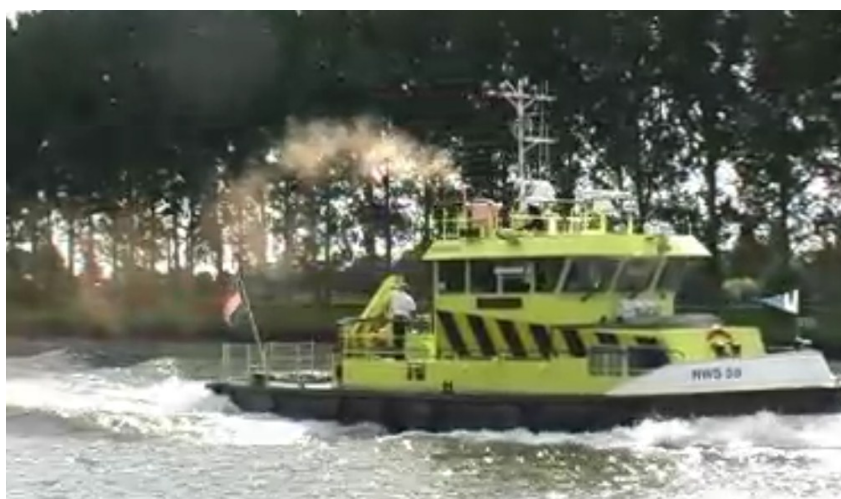
Figuur 15 Veldexperiment met de RWS59 op 15 augustus 2014: duidelijk is te zien dat de rookpluim van het schip achter de opbouw neerwaarts wordt getrokken
