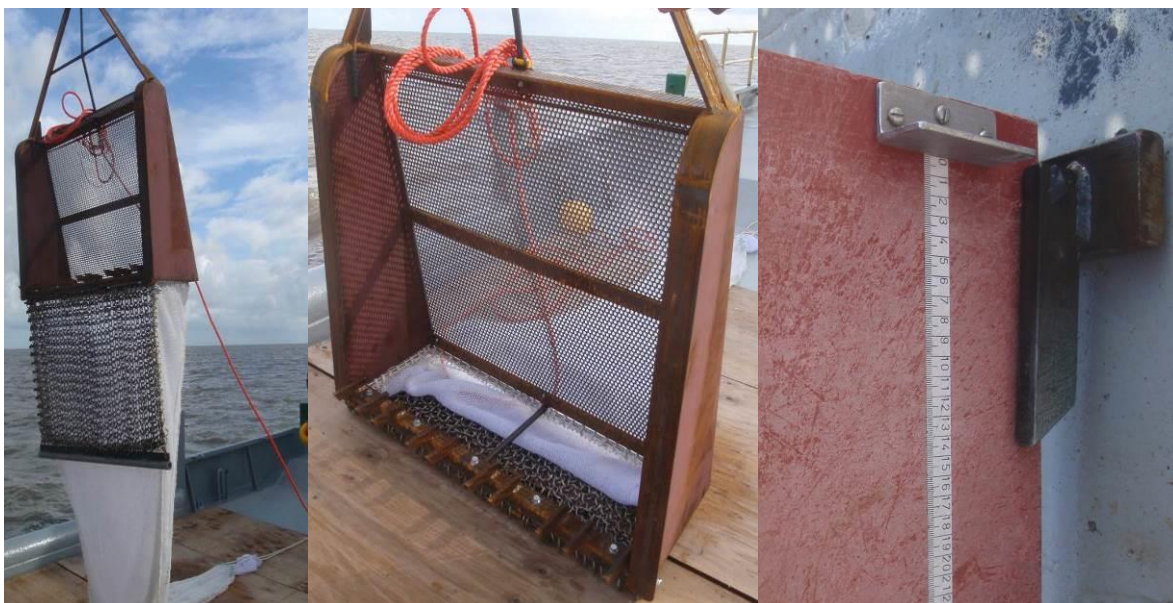
Figuur 2.2: De zandspieringkor hangend met de kettingmat achter de tanden (linker figuur), de kor staand op de tanden (middelste figuur) en een van de tanden met een totale lengte van 15 cm, waarvan 10 cm uitstekend om in de bodem door te dringen (rechterfiguur).
