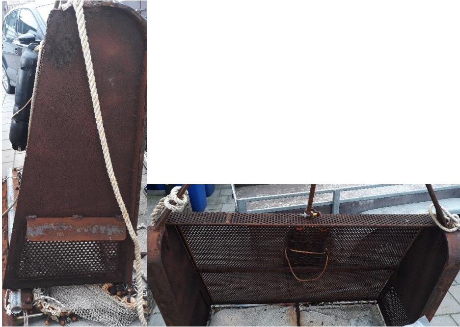
Figuur 2.3: De zandspieringkor: aanpassingen uitgevoerd voor de Amelander Zeegat bemonstering 2018. Links een rooster in de zijkant en rechts rooster aan de voorkant.
