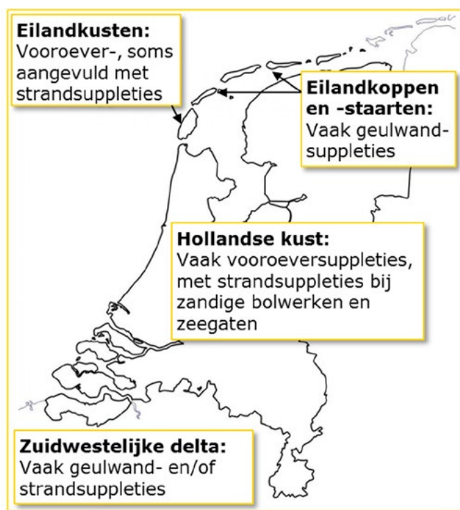
Figuur 4.5 Figuur met verschillende gangbare vormen van suppleties en een indicatie van de toepasbaarheid langs de kust.
