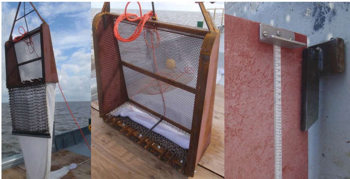
Figuur 4: De zandspieringkor hangend met de kettingmat achter de tanden (linker figuur), de kor staand op de tanden (middelste figuur) en één van de tanden met een totale lengte van 15 cm, waarvan 10 cm uitstekend om in de bodem door te dringen (rechterfiguur).
