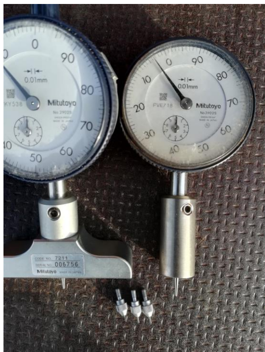
Figuur 5-7: voorbeeld corrosie putdieptemeters
