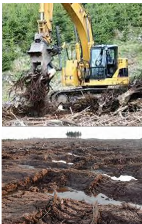
Figuur 30 Stronk oogsten en resulterende bodemstructuur
