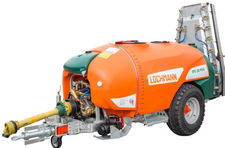
Foto 2: Semi dwarsstroomspuit/dwarsstroomspuit met gedeeltelijke luchtuitstroomopbouw
