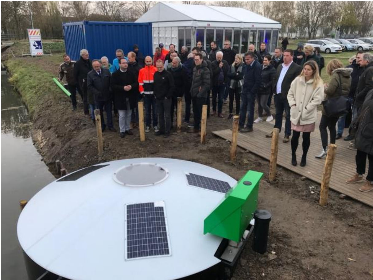
Figuur 31: Innovatieve smart vislift (volgens Nautilus ontwerp) in Almkerk is de 'Apple Iphone' onder de vispassages. Bron: AD.
