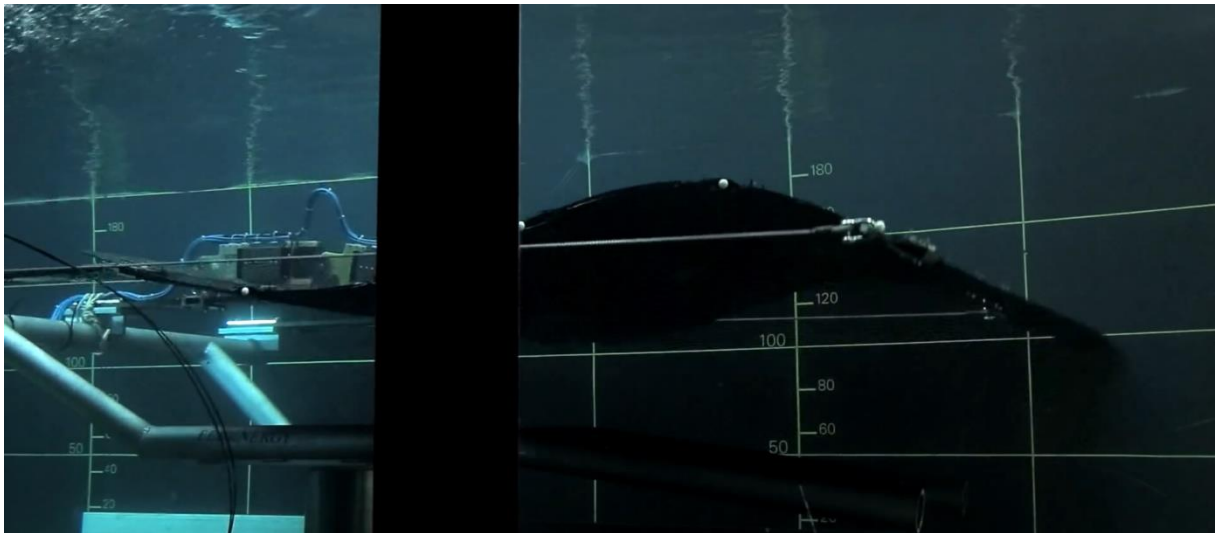
Figuur 21: Getijdenenergie op basis van de zwembewegingen van een paling. Bron: EEL ENERGY @ COP21 https://www.youtube.com/watch?v=Sy9ozCp6CqI&feature=youtu.be
