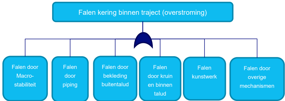
Figuur 3-5: Foutenboom leidend tot overstroming op traject niveau als gevolg van de verschillende mechanismen
