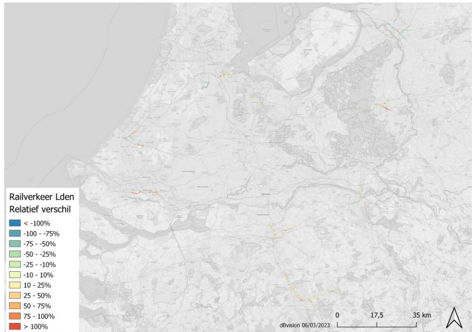
Figuur 49 Relatief verschil in gemiddelde geluidbelasting L_{den} per hectare vanwege railverkeer per hexagoon (2021 min 2016)
