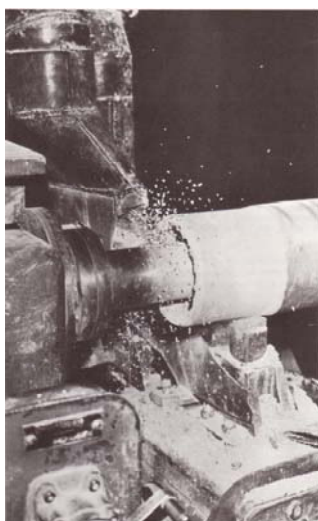
Figuur 19: Asbeststof bij het afdraaien van buizen en breuk bij transport
