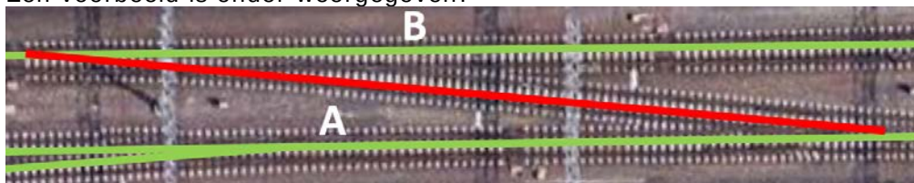
Figuur 9: Voorbeeld van een wisselboog.
