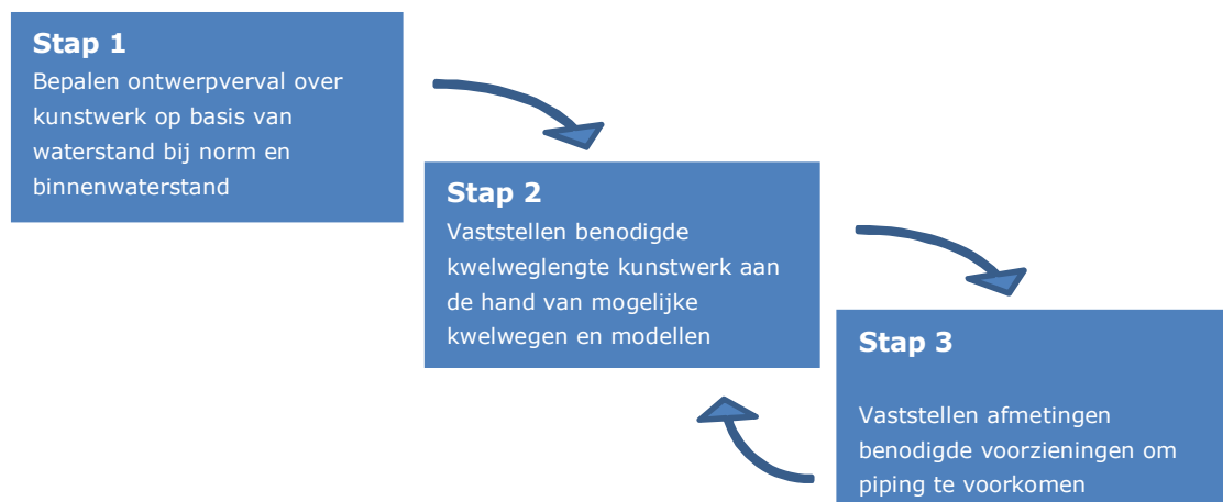
Figuur 24 Stappenplan voor ontwerp faalmechanisme piping
