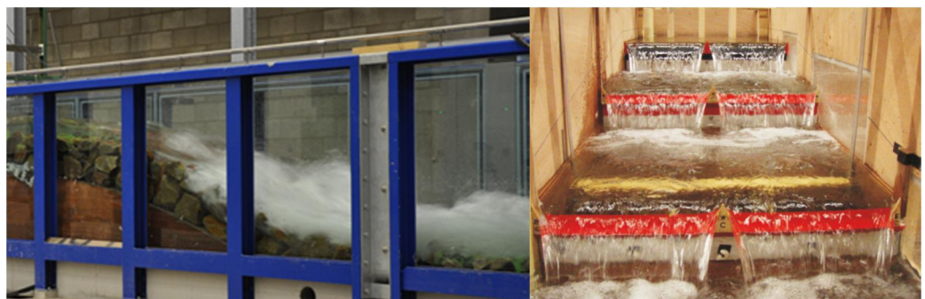
Figuur 49 2D Fysiek modelonderzoek bodembeschermingen (bron: Deltares)
