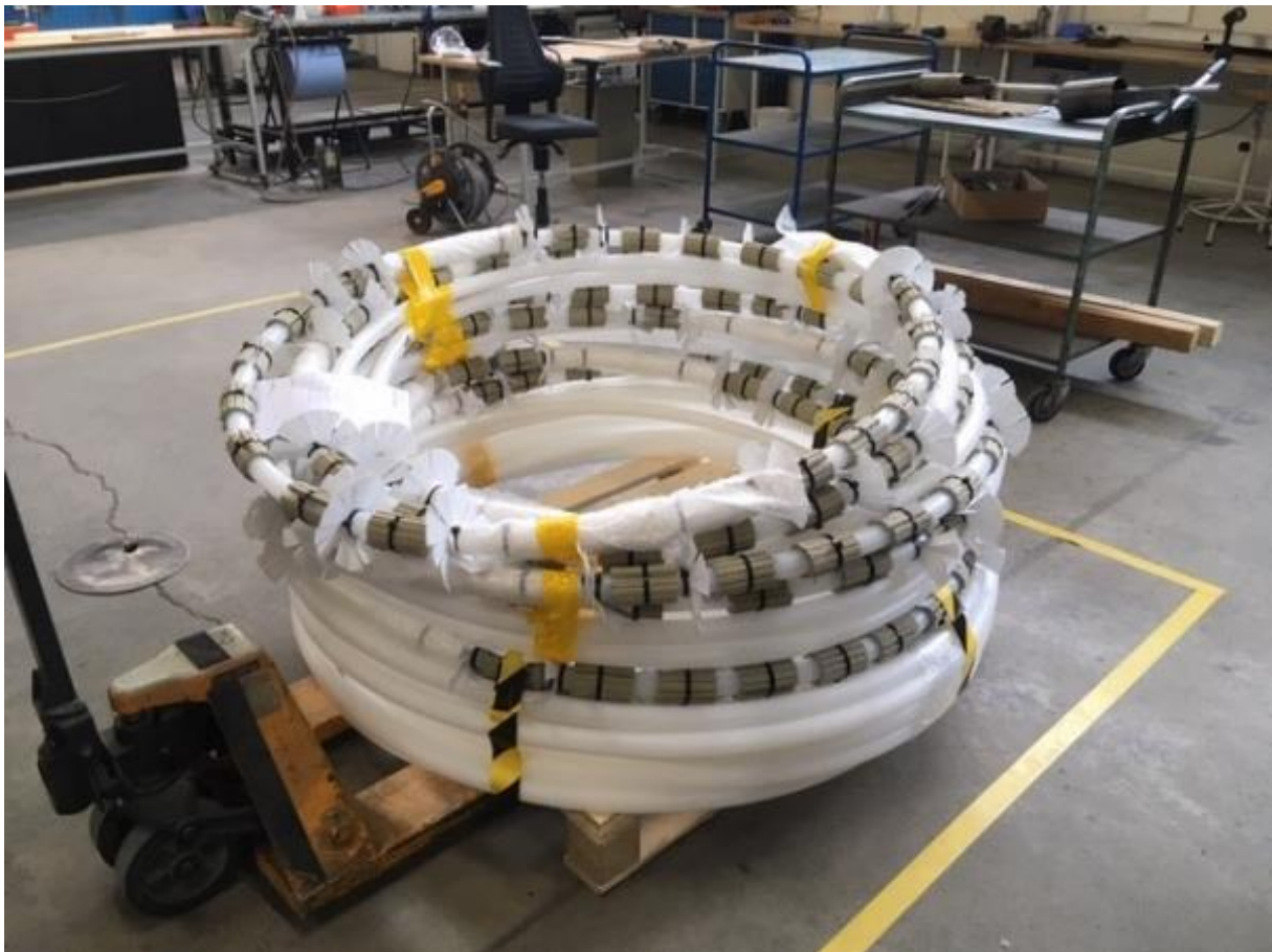
Figuur 10. Multilevel samplers klaar voor installatie in het Griftpark
