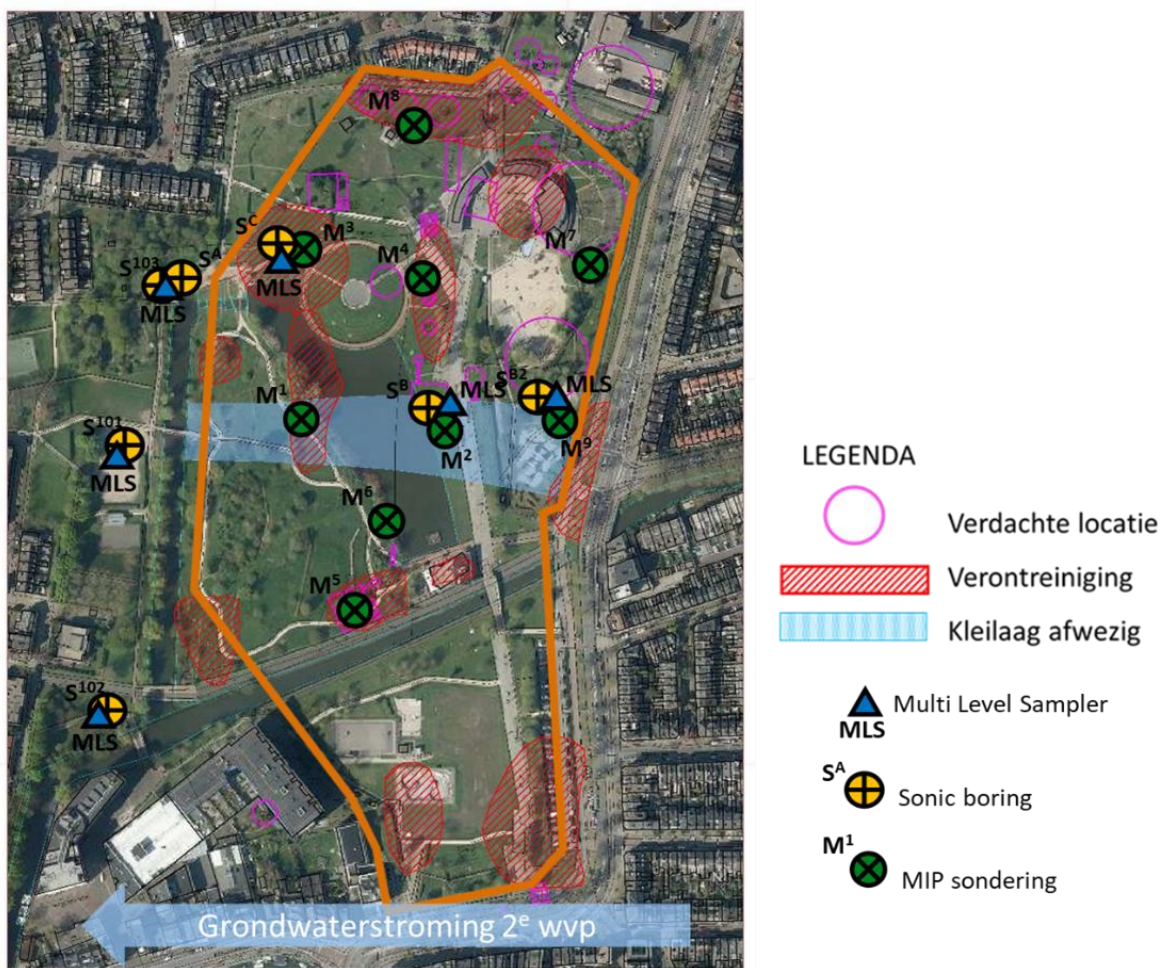
Figuur 8. Overzicht van de in het BestParc project geplaatste MIP sonderingen (groene markeringen), sonische boringen (gele markeringen) en multi level sampler filters (blauwe markeringen)
